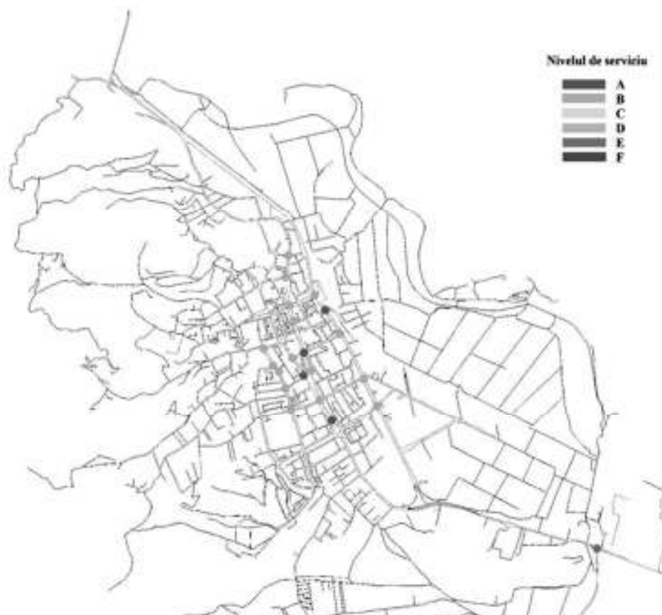
Fig. 89. Nivelul de serviciu al intersecțiilor, scenariul „A face minimum”, ora de vârf AM, 2016
