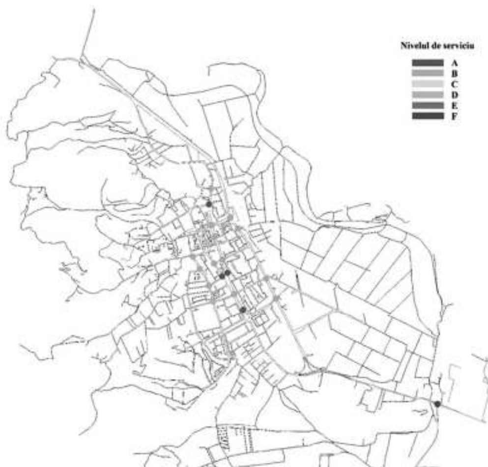
Fig. 91. Nivelul de serviciu al intersecțiilor, scenariul „A face minimum”, ora de vârf AM, 2030
