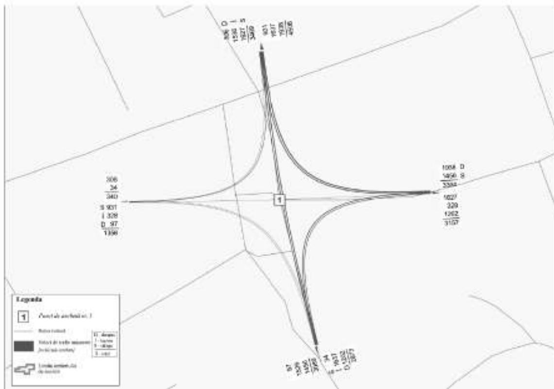
Figura 4.4. Fluxuri de vehicule etalon - punct de contorizare 1 (imagine rotită cu 90°).
